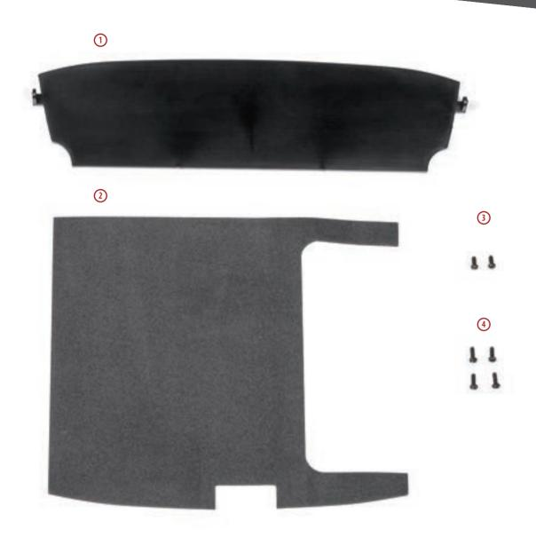
$\mathbf{1}$  — обивка багажника передняя;  $\mathbf{2}$  — обивка пола багажника;  $\mathbf{3}$  — винт 1,7 $\times$ 4 (AP) — 2 шт.;  $\mathbf{4}$  — винт 1,7 $\times$ 5 (BP) — 4 шт.
