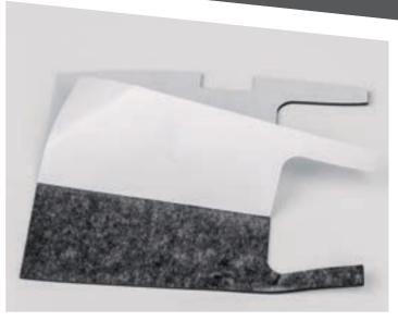
Перед монтажом обивки проверьте ее совмещение с полом багажника. Обивка не должна выходить за габариты пола с его задней стороны. Удостоверьтесь в совмещении прорези обивки с нишей запасного колеса. Удалите защитный слой с нижней стороны обивки пола багажника.
